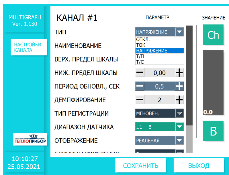
Рисунок 2.14 – Выбор типа измеряемых сигналов
