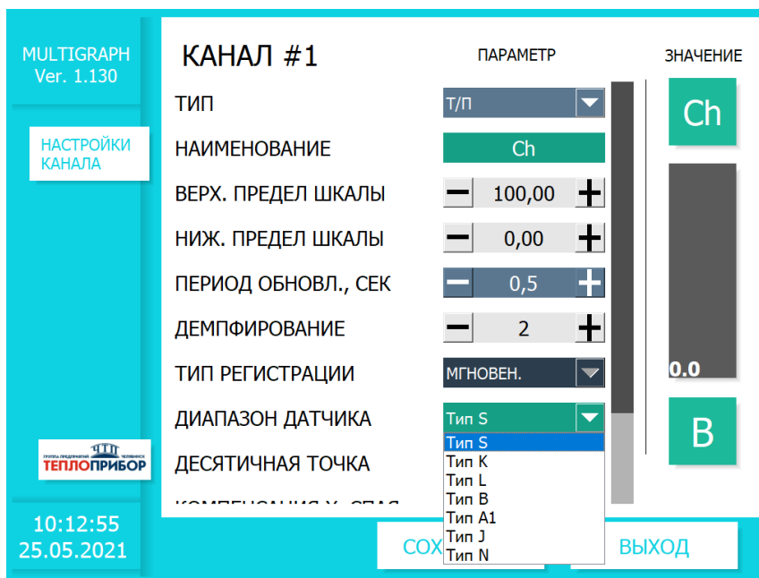
Рисунок 2.17 – Параметры настройки входа измерения термопар
