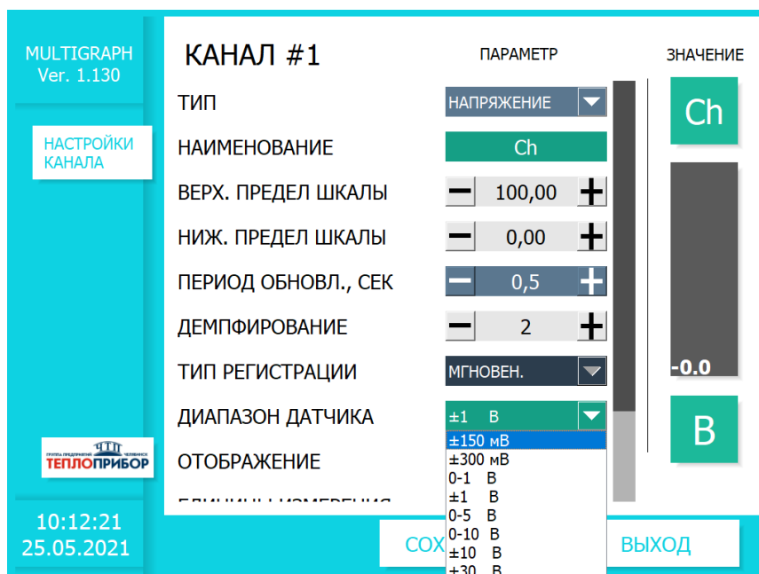
Рисунок 2.16 – Параметры настройки входа измерения напряжения
