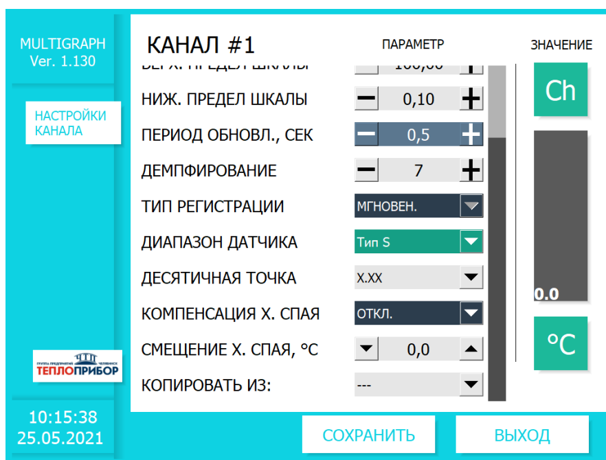
Рисунок 2.21 – Компенсация холодного спая
