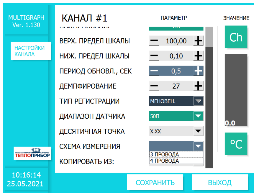
Рисунок 2.22 – Настройка схем измерения термосопротивлений
